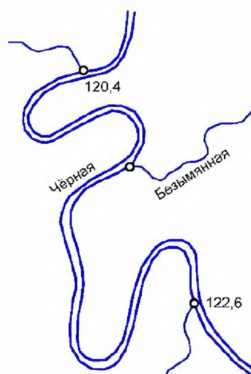
Рисунок 8.3 – Пример определения высоты уреза воды
