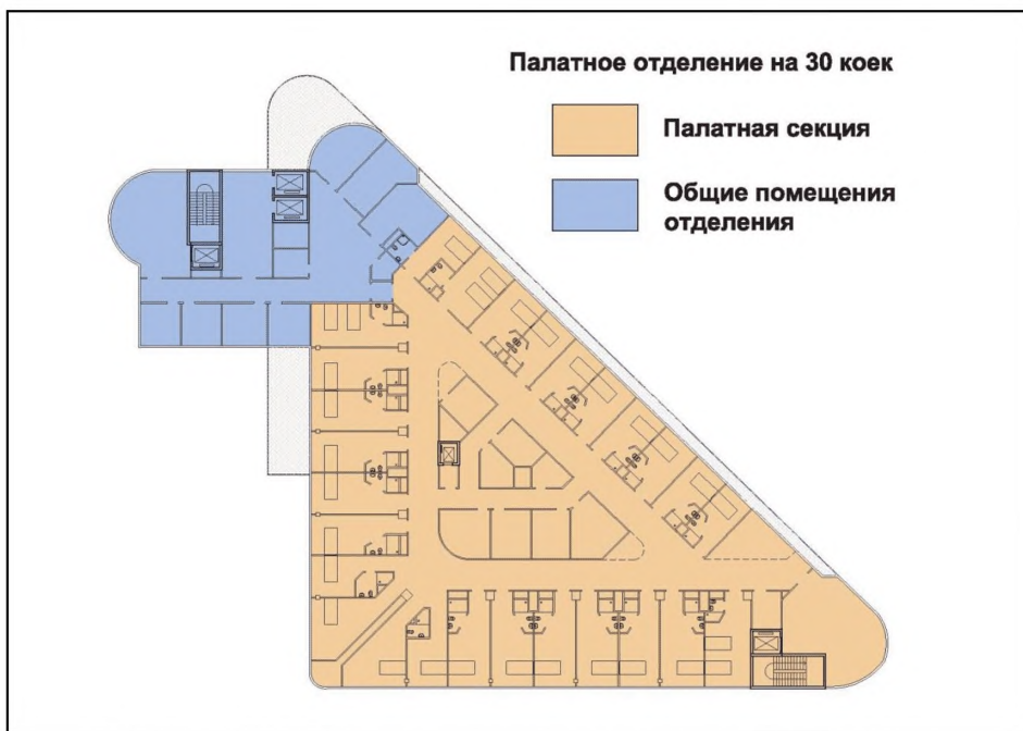
Рисунок 19 – Пример планировки палатного отделения
