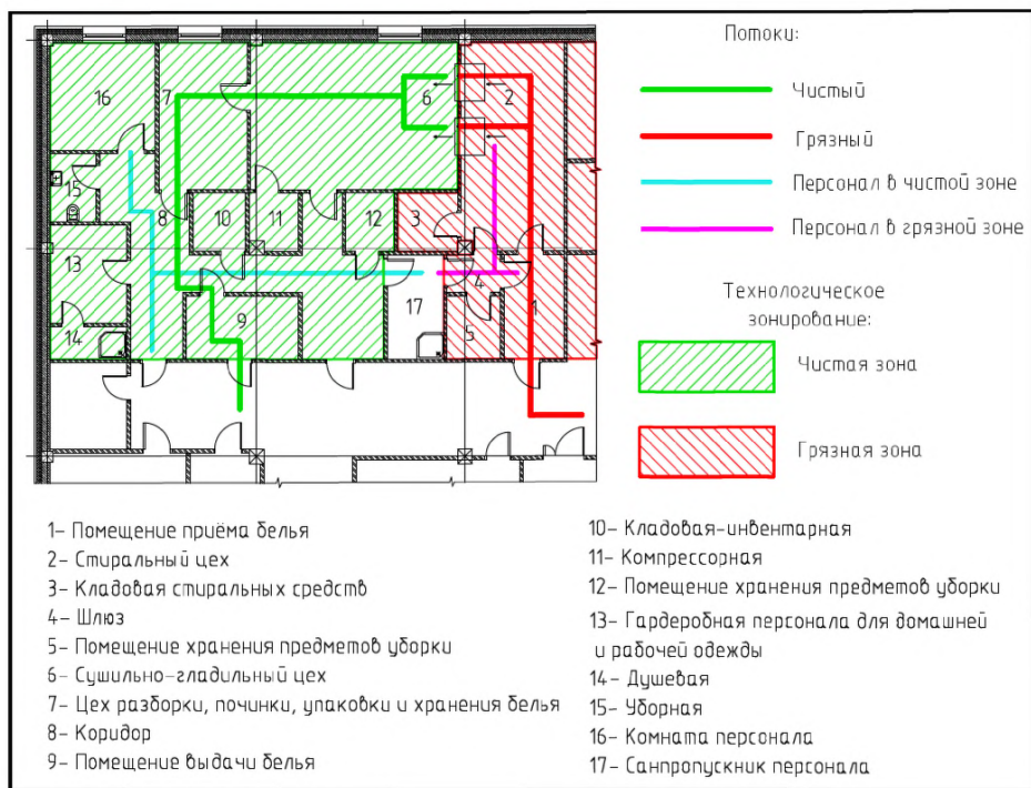
Рисунок 43 – Пример планировочного решения и технологического зонирования прачечной
