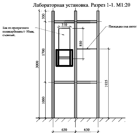
Рисунок А.6 – Эскиз лабораторной установки для генерации волн цунами в гидравлическом лотке с переменным уклоном
