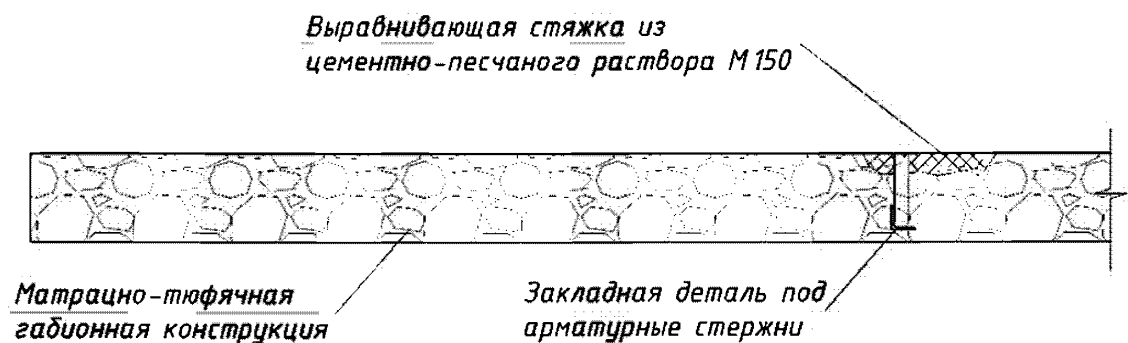
Рисунок Ж.3 – Установка закладной детали в матрацно-тюфячную габионную конструкцию
