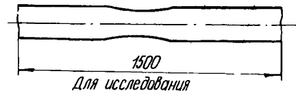
Рис.4. Смятие тела трубы
