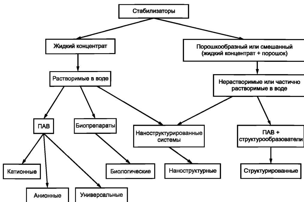
Рисунок А.1 — Общая классификация стабилизаторов грунтов, применяемых в дорожном строительстве
