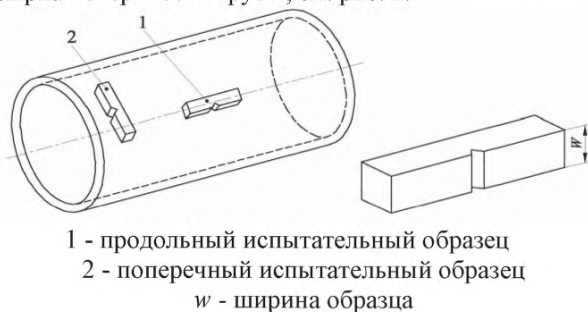
Рисунок 2 — Ориентация образца для испытания на удар
