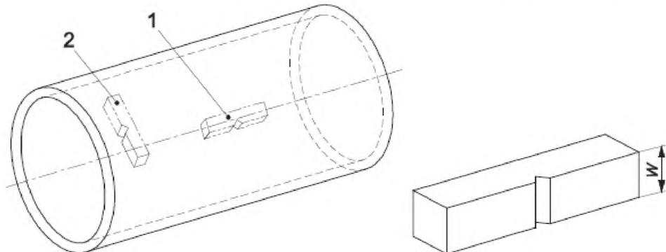
где 1 – продольный образец для испытания;
