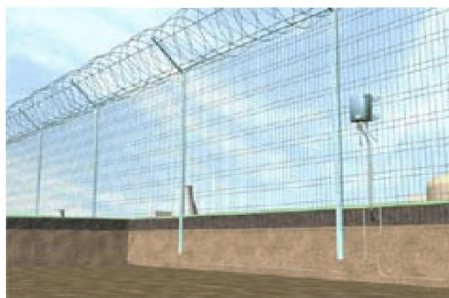
Рисунок 2.24 – Установка ЧЭ для определения подкопа
