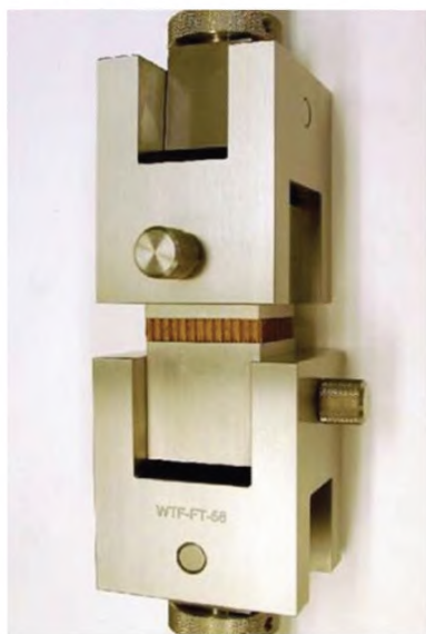
Рисунок 1 — Приспособление для нагружения для определения предела прочности на растяжение перпендикулярно к плоскости «сэндвич»-конструкции
