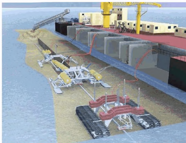
Рис. 7.6-3 Комплексное устройство для заглубления и обратной засыпки подводного трубопровода компании Saipem S.p.A.
