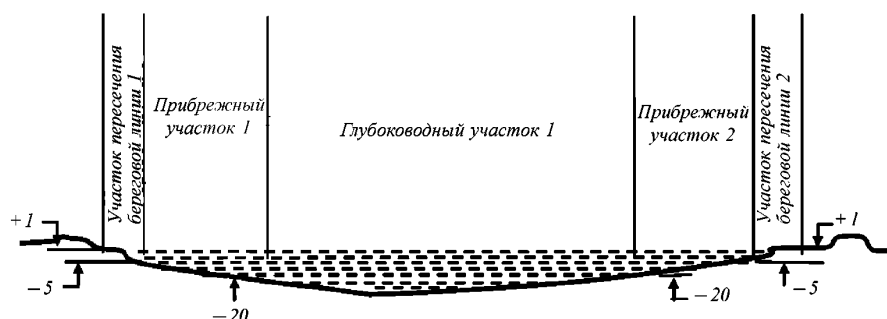
Рис. 10.1-1 Участки трассы морского трубопровода [3]
