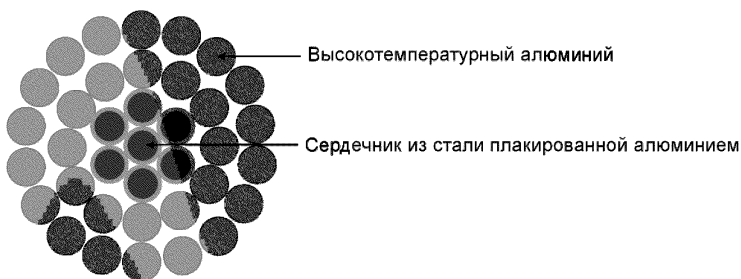
Рисунок В10. Сечение провода TACSR/ACS
