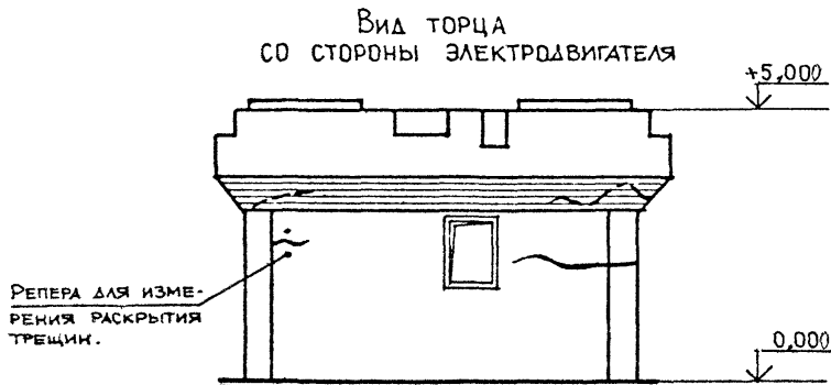
Дис.21 Расположение трещин и маяков на боковых поверхностях фундамента компрессора 2ШЛК-1420.
