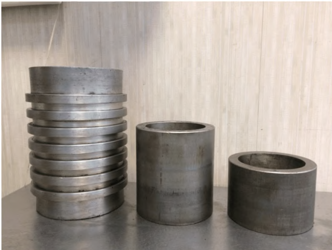
Рисунок 3 – Цилиндрическая форма диаметром 101,0 мм и два вкладыша, предназначенная для приготовления асфальтобетонных образцов из крупнозернистых асфальтобетонных смесей
