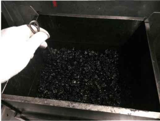
Рисунок 24 – Штыкование асфальтобетонной смеси
