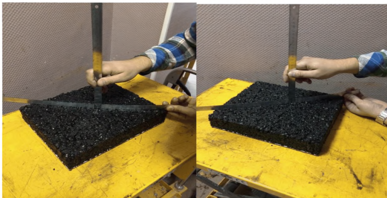
Рисунок - 28 Определение ровности образца-плиты во взаимно-перпендикулярных плоскостях
