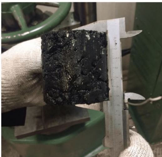
Рисунок 9 – Измерение асфальтобетонного образца штангенциркулем
