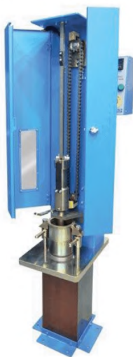
Рисунок 14 – Автоматическая установка Маршалла
