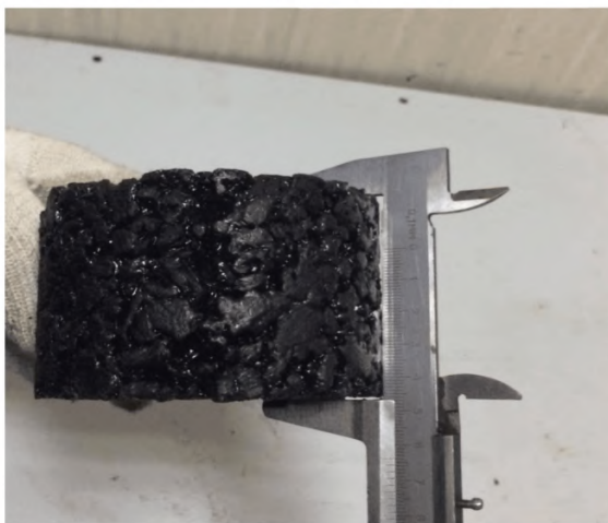
Рисунок 21 – Измерение асфальтобетонного образца штангенциркулем
