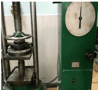
Рисунок 6 – Уплотнение асфальтобетонной смеси на прессе П-50
