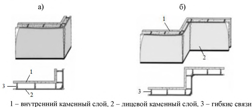
Рисунок 6.2 Пространственная конечно-элементная расчетная модель фрагмента многослойной стены в пределах этажа для определения напряженно-деформированного состояния от температурных воздействий на Г-образном (а) и Z-образном (б) участках
