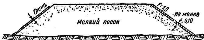
Фиг. 145. Покрытие откосов глиной
