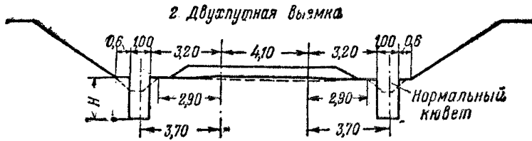
Фиг. 21. Расположение продольного лотка в двухпутной выемке
