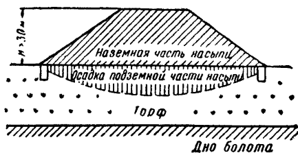
Фиг. 59. Схема возведения насыпи высотой 3 м и более на болотах первого типа
