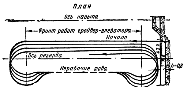
Фиг. 98. Схема движения грейдер-элеватора
