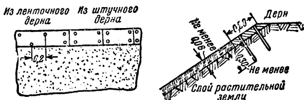
Фиг. 146. Укрепление бровки насыпей дерновой лентой
