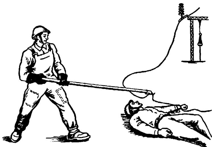
Рис. 6. Освобождение пострадавшего от действия тока в установках выше 1000 В отбрасыванием провода изолирующей штангой
