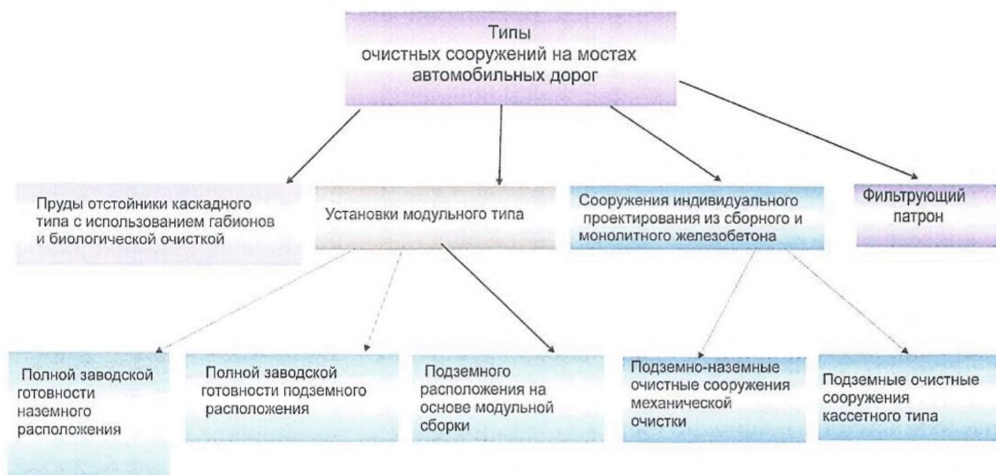
Рисунок В.1 – Типы очистных сооружений на мостах
