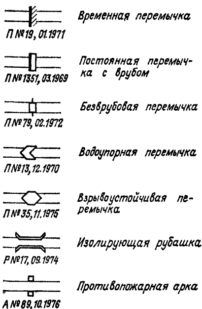
Рис. 7.1. Условные обозначения изолирующих сооружений
