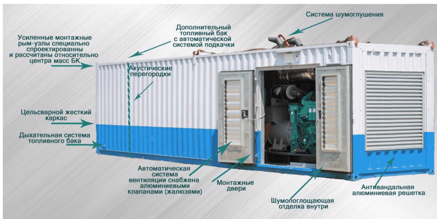
Рисунок 5.2.4 – Блок-контейнер для установки ДГУ / ДЭС
