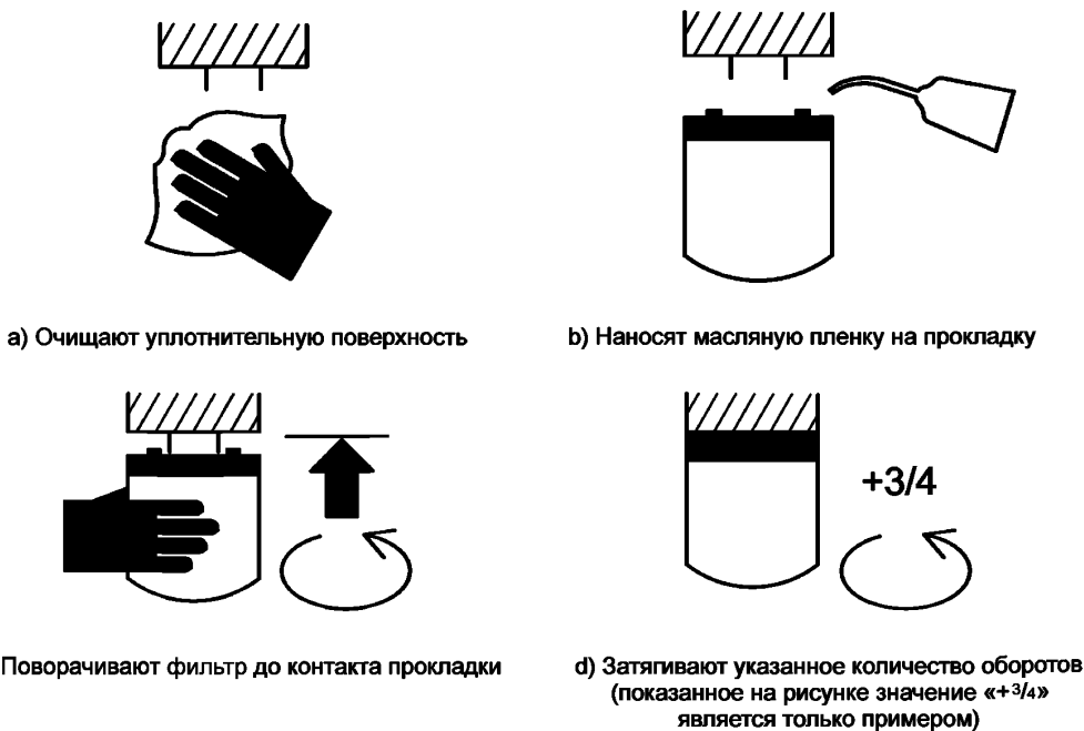
Рисунок 6 — Установка и последовательность закручивания фильтра
