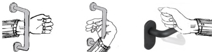
Рисунок 6.59 – Способ открывания П-образной ручки инвалидом с нарушенной функцией рук
