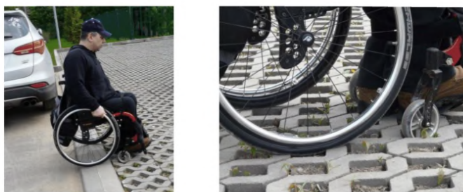
Рисунок 5.32 – Парковочные места для транспорта инвалидов на георешетке недопустимы
