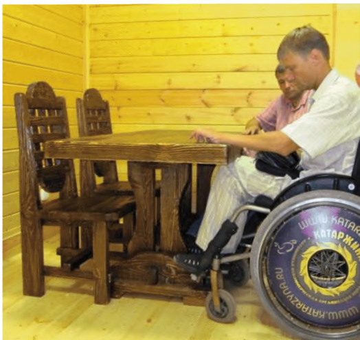
Массивная столешница и ножки не позволяет вплотную подъехать к столу
