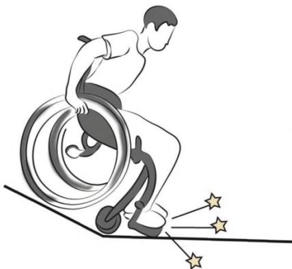
Рисунок 5.12 – Травмоопасная ситуация для человека в кресле-коляске при крутом спуске
