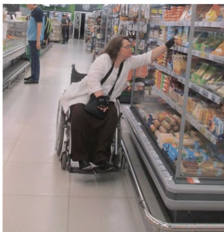
Рисунок 7.6 Ограничители для защиты стеклянных витрин неудобны инвалидам на кресле-коляске
