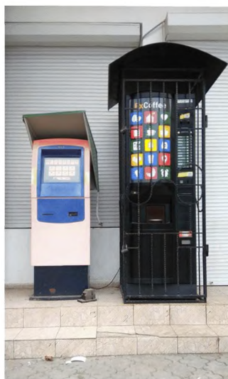
Не обеспечен безбарьерный подход к автомату
