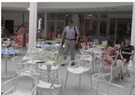
Рисунок 8.6 – Хаотичная расстановка столиков дезориентирует слепого посетителя
