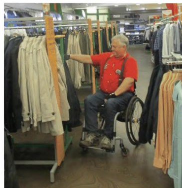
Рисунок 7.11 – Досягаемость вешалок с одеждой для инвалида на кресле-коляске
