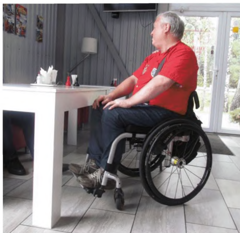
К столу невозможно подъехать на кресле-коляске из-за широкого подстоля
