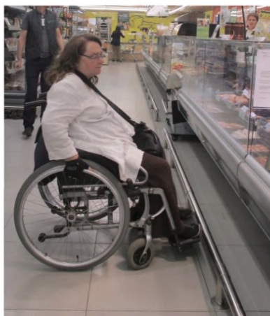
Рисунок 7.6 Ограничители для защиты стеклянных витрин неудобны инвалидам на кресле-коляске
