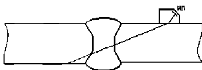
А. Схема прозвучивания стыкового сварного соединения прямым лучом
