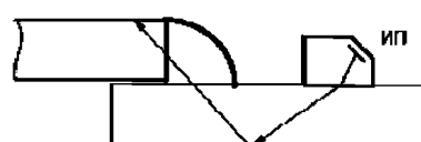
Г. Схема прозвучивания таврового сварного соединения однократно-отраженным лучом
