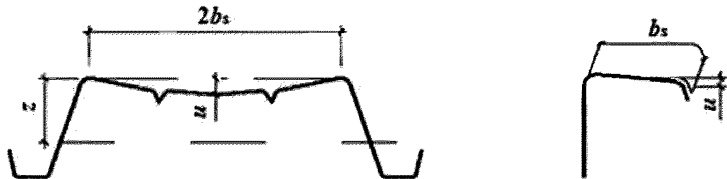
Рисунок 7.5 – Пример кривизны полки профиля, прямолинейного до приложения нагрузки
