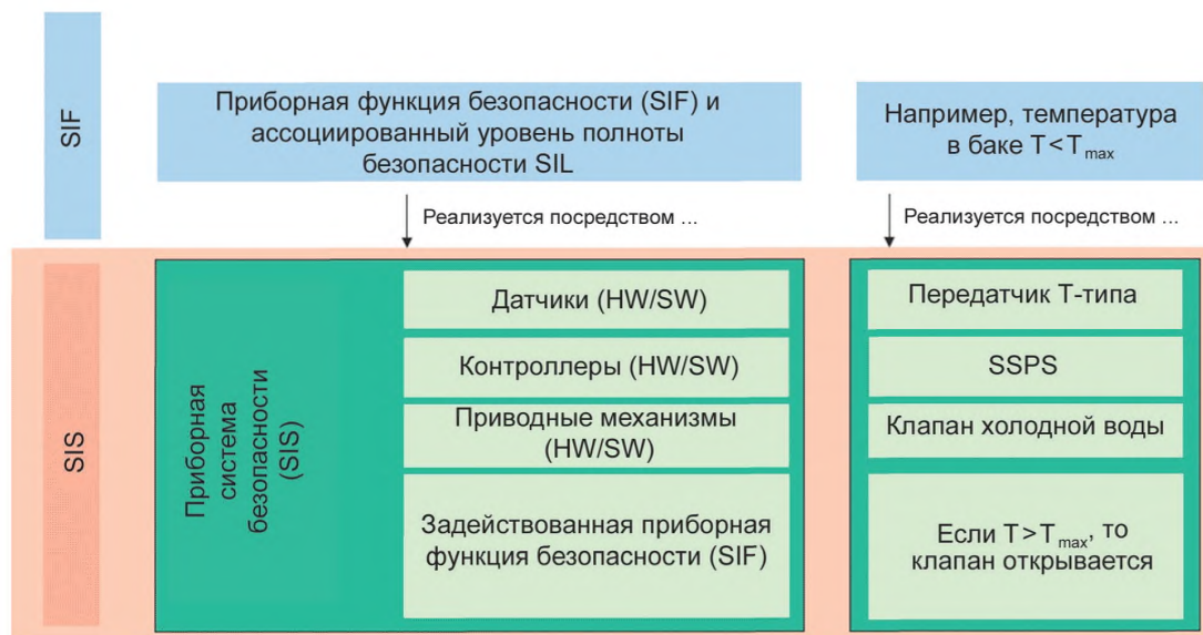
Рисунок 2 — Классификация терминов приборные функции безопасности (SIF) и приборные системы безопасности (SIS)
