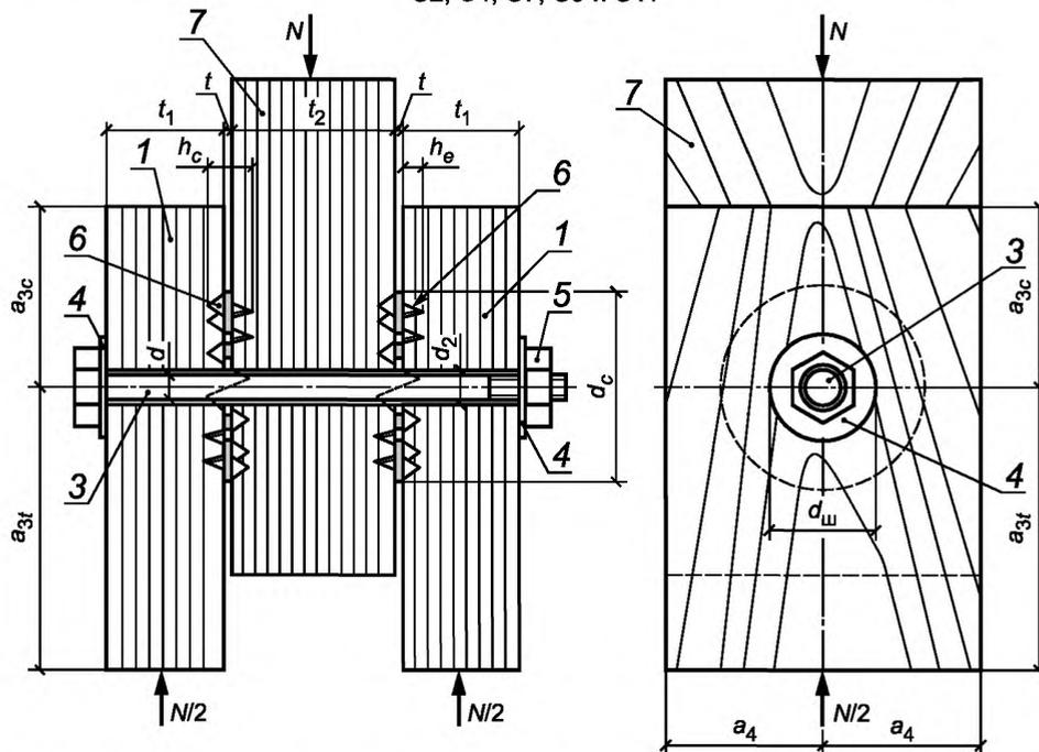
б) Схемы образцов двухсрезного соединения с двухсторонними зубчатыми шпонками типов С1, С5, С6, С8 и С10
