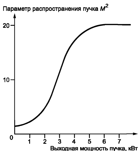
Рисунок 15 — Параметр распространения пучка M^2 в зависимости от выходной мощности
