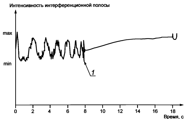
Рисунок 11 — Полосы интерферометра Майкельсона, плоский германий
