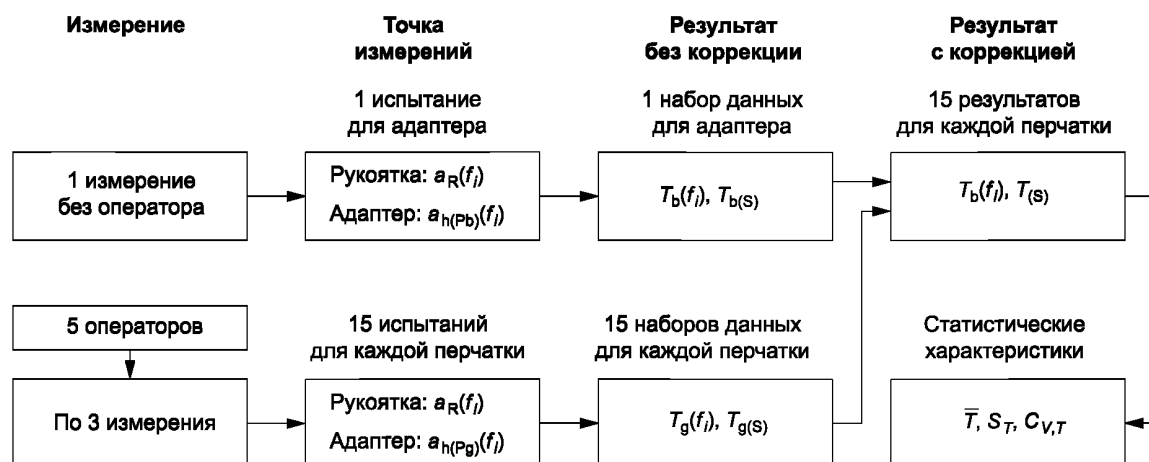
Рисунок 10 — Блок-схема определения среднего скорректированного коэффициента передачи перчатки, его стандартного отклонения и коэффициента вариации
