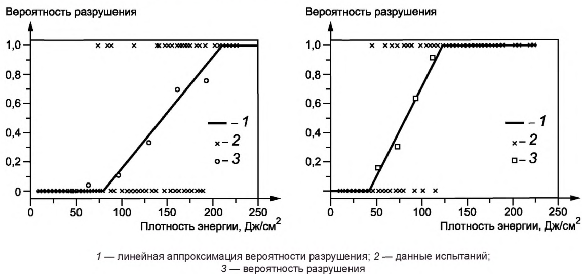
Рисунок D.4 — Графики распределения вероятности разрушения образца 1 на двух разных уровнях ПЛР
