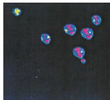
в) Участки с разрушением, обнаруженные с помощью алгоритма сравнения изображений с отображением в псевдоцветах
