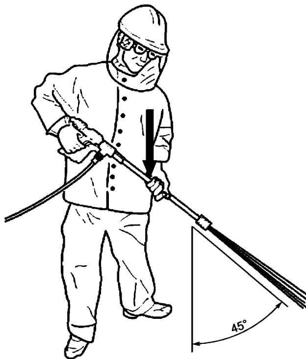
Рисунок DD.5 — Рабочие условия. Положение пистолета-распылителя
