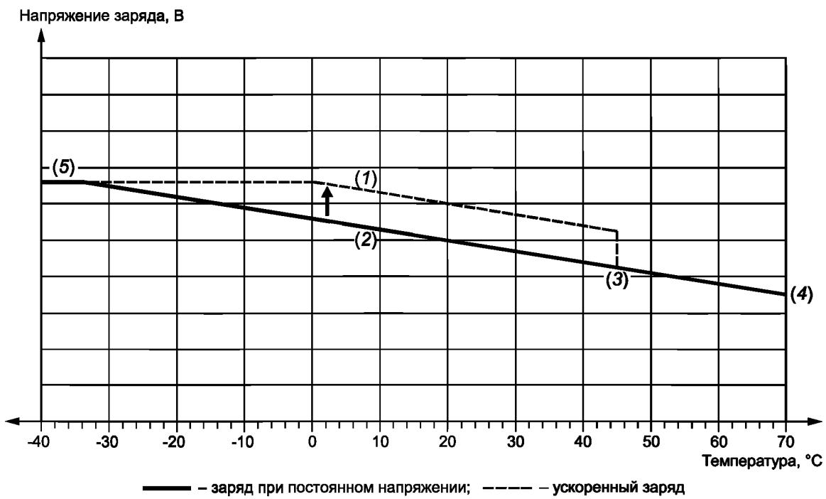
П р и м е ч а н и е — На рисунке показан заряд с температурной компенсацией 3 мВ/°C/аккумулятор, основанной на 20 °C для заряда никель-кадмийевых батарей при постоянном напряжении (один или два уровня) с ограничением значения тока.
