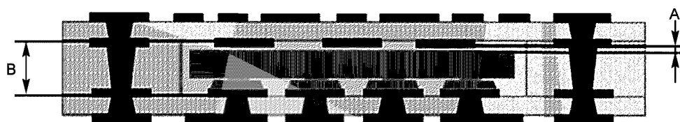
Рисунок 1 — Измеряемые компоненты структуры с микрошлифом отверстия
