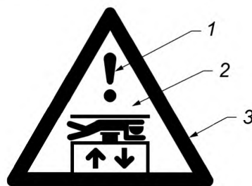
Рисунок 1 — Знак «Опасность снизу — Ограниченное пространство — Соблюдайте осторожность»
