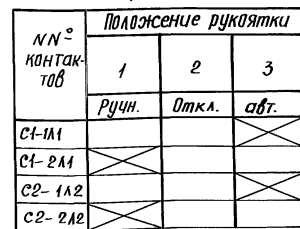
Диаграмма замыкания контактов переключателей SA1, SA2, SA3
