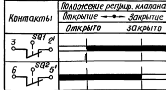
Диаграмма замыкания конечных выключателей исполнительного механизма МВ1
