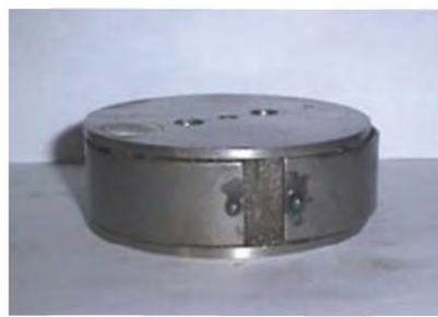
Рисунок 17 — Кольцевая форма в сборе (вид сбоку)
