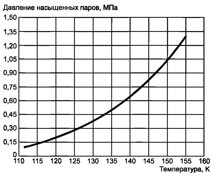
Рисунок А.1 — Равновесные температура и давление жидкого метана
