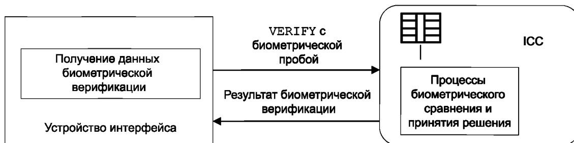
Рисунок А.3 — Пример процедуры статической биометрической верификации, использующей биометрическое сравнение на идентификационной карте
