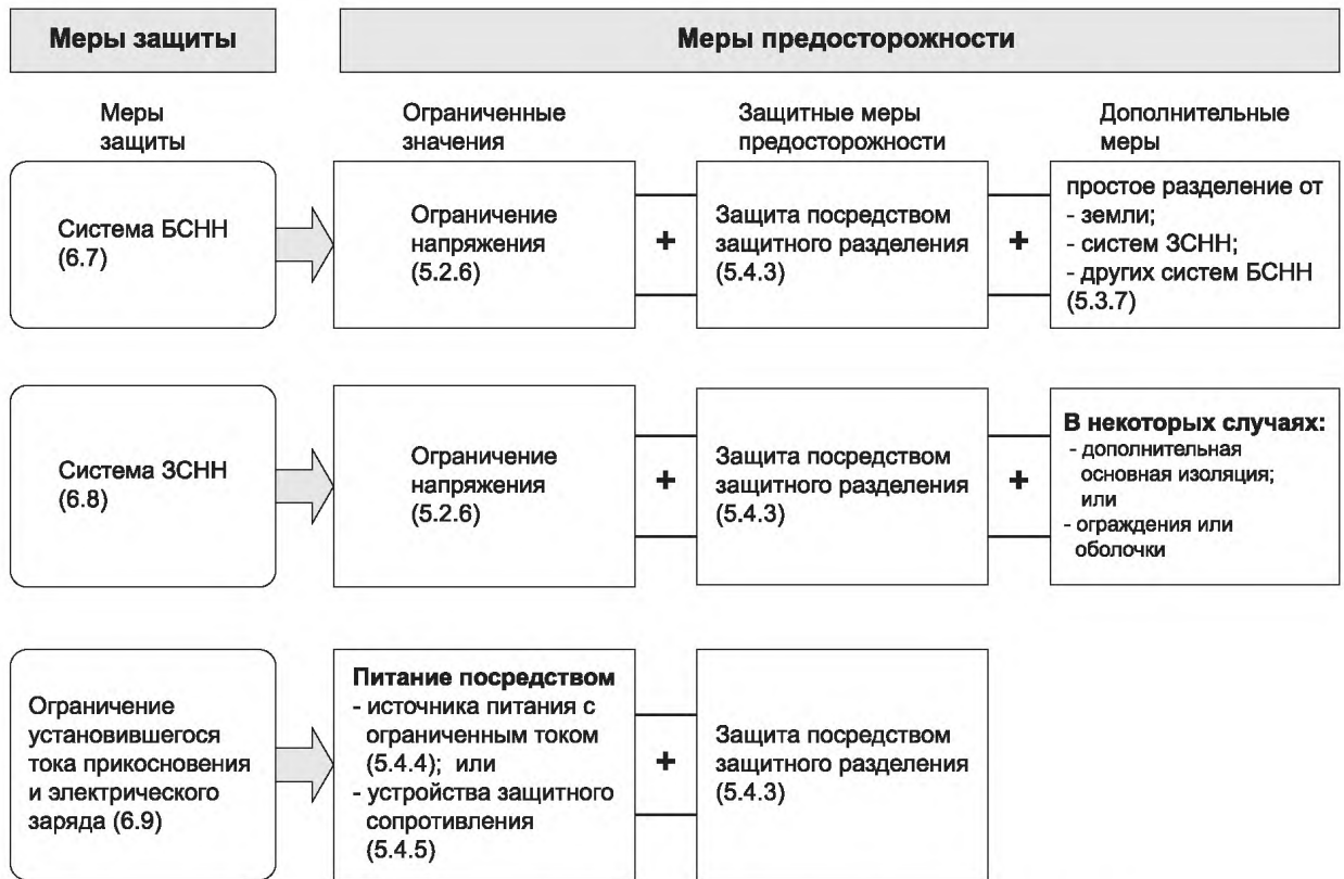
Рисунок А.2 — Меры защиты с ограничением значений электрических величин
