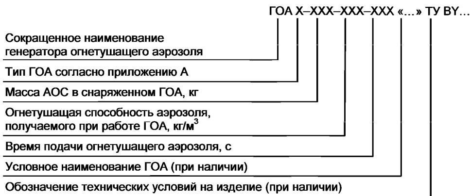
*Пример условного обозначения генератора огнетушащего аэрозоля второго типа с массой заряда АОС в снаряженном генераторе 2 кг, огнетушащей способностью аэрозоля, получаемого при работе ГОА, 0,28 кг/м<sup>3</sup>, временем подачи огнетушащего аэрозоля 30 с, условного наименования «Туман-2», изготовленного согласно ТУ ВY...:*
