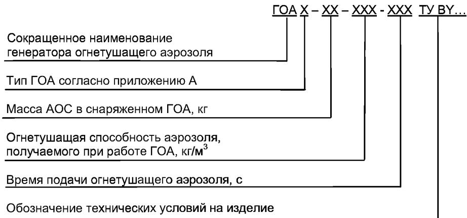
Пример условного обозначения генератора огнетушащего аэрозоля второго типа с массой заряда АОС в снаряженном генераторе 2 кг, огнетушащей способностью аэрозоля, получаемого при работе ГОА, 0,28 кг/м<sup>3</sup>, временем подачи огнетушащего аэрозоля 30 с, изготовленного согласно ТУ BY...:
