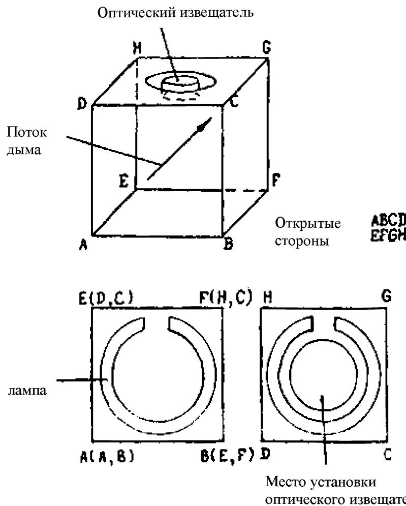
Рисунок Г.1 - Устройство для проверки сохранения работоспособности оптических извещателей при воздействии фоновой освещенности
