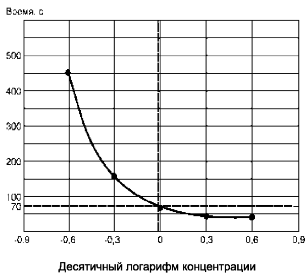
Рисунок 16 – Определение показателя смачивающей способности пенообразователя с рабочей объемной концентрацией 1 %
