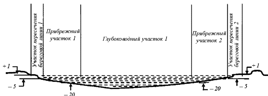
Рис. 10.1-1 Участки трассы морского трубопровода [3]
