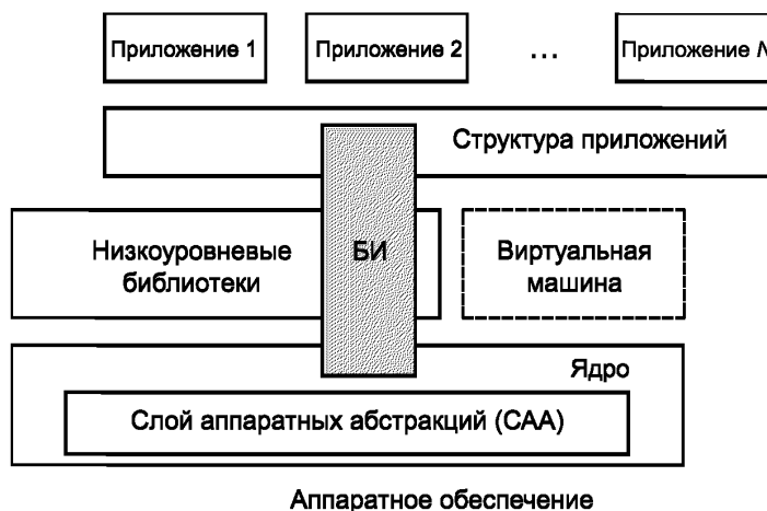
Рисунок 2 — Расположение биометрического интерфейса при разработке внутри операционной системы
