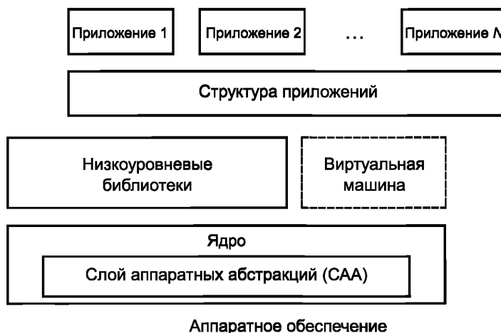
Рисунок 1 — Общая архитектура операционной системы мобильного устройства
