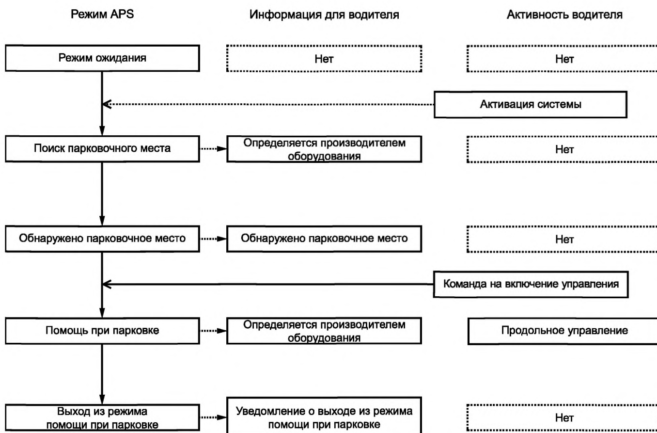
Рисунок 14 — Диаграмма режимов работы APS типа 2
