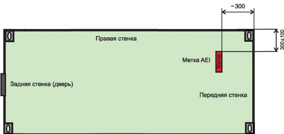
Рисунок 3 — Область монтажа на интермодальных транспортных единицах: контейнер ИСО
