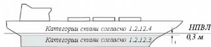
Рис. 1.2.12.3 Требования к категории стали для надводной и подводной части наружной обшивки
