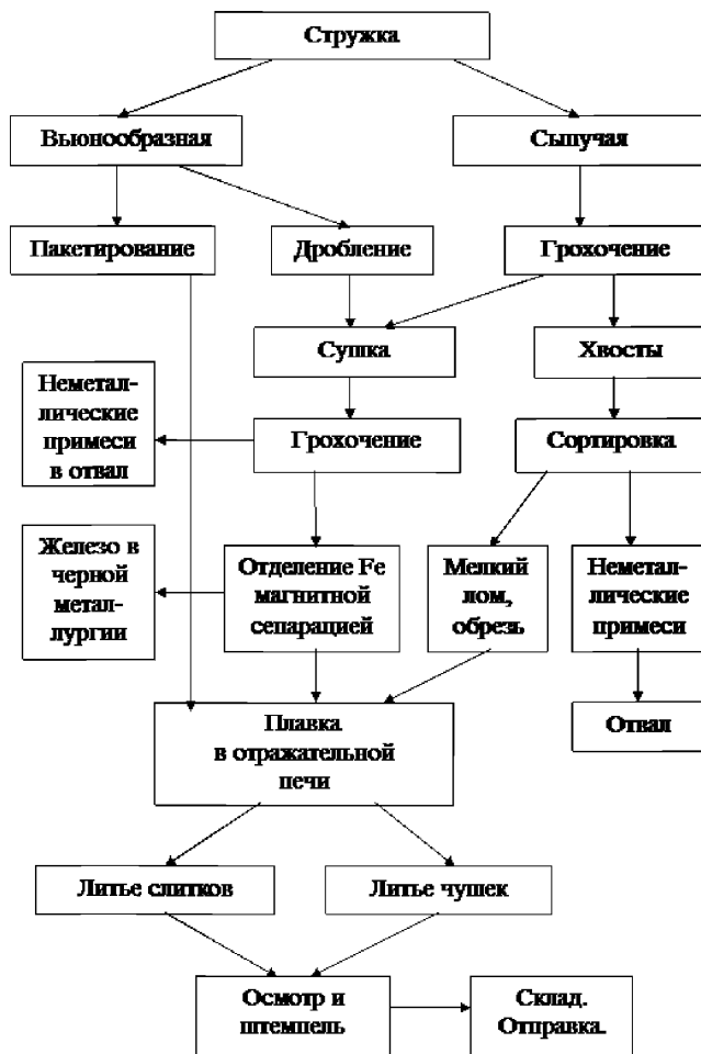
Рисунок 8.6 – Технологическая схема подготовки и плавки стружки
