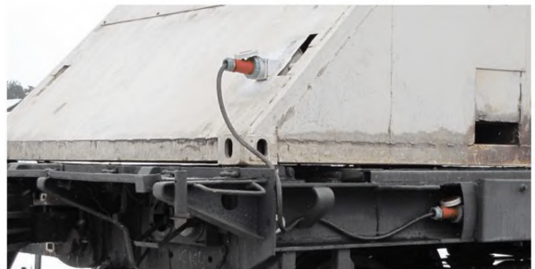
Рисунок 69 – Примеры подключения АДГУ к сети электроснабжения платформы а – подключение АДГУ «Прогрессор-01»; б – подключение АДГУ РКВ-15
