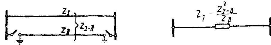
а) Исходная схема и схема замещения двух параллельных линий при заземлении одной из них с обоих концов.
